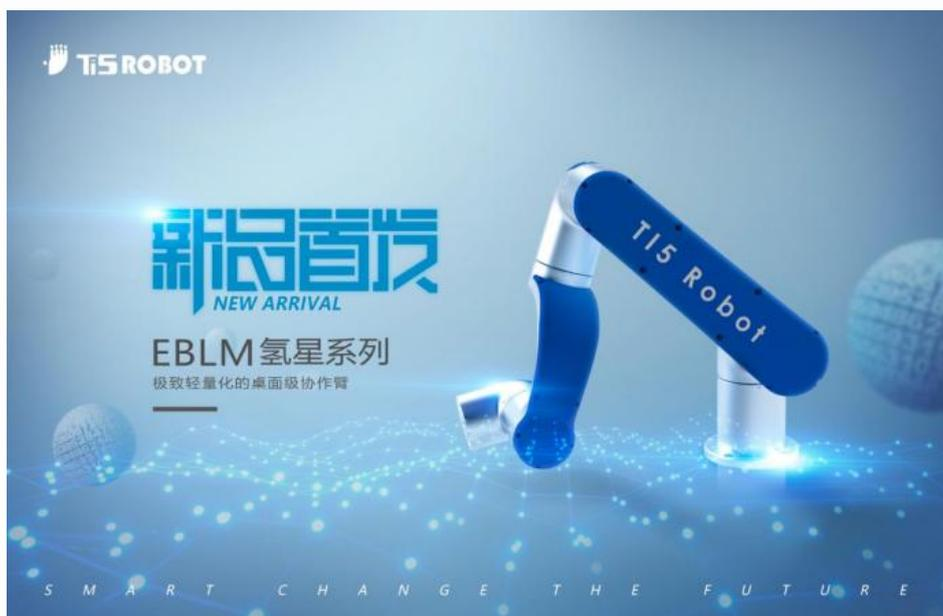
如同名字来源——最小恒星 EBLM J0555-57Ab 一般，自重仅 2.3kg 的 Eblm 氢星系列，作为桌面级协作机器人做到了极致轻量化。6 个自由度，精致小巧又不失高度灵活。精准定位，重复定位精度更是达到了 0.05mm。硬核的产品配置，
