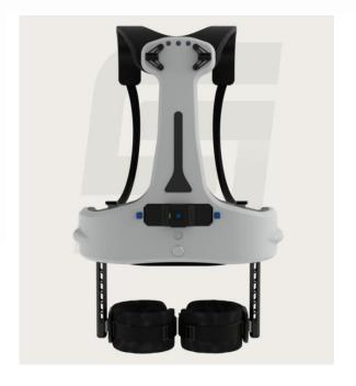
产品自重减轻,使穿戴更加轻松、背负无负担。动力提升 20%: 阻尼缓冲系统,传动系统更新,动力密度提高。助行速度最大达 7.5km/h,模拟人体自然运动步态,提高腿部运动机能。产品拥有 3 种模式、4 种功能,智能手控器加持,交互设计集成化,灵活切换,轻松驾驭,体验更直观操作。5-8 小时续航,满足整日使用需求,支持快速更换,解决续航焦虑。
