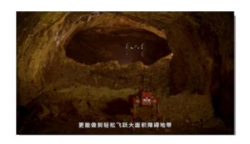
参加本次探索挑战的还有球形机器人、伴随机器人、履带式采样分析机器人、空地两用机器人以及带作业机械臂履带机器人等多个机型。绝影 X20 与"天马"空地机器人首次在洞穴坏境中开展"机狗协同"勘探测试,深入复杂地形与高处狭窄地带。
