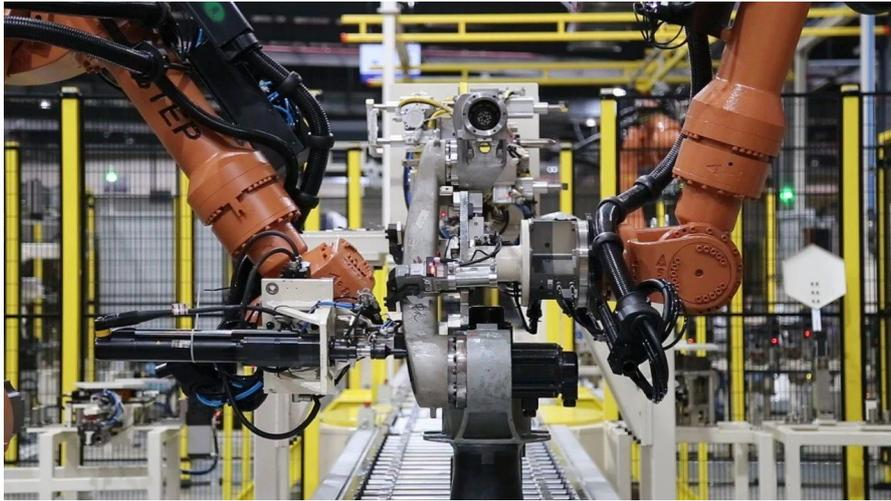
新时达智能工厂率先尝试打造复杂离散制造，也就是在不同地方由机器人分别制造零部件，最后再由机器人完成总装集成，目前这个超级工厂已具备年产6轴工业机器人1万台，机器人柔性工作站500套的生产能力。随着批量机器人的投入使用，用工量可减少80%，产品测试一次性通过率上升15%，单位面积产出效率提升30%以上。
