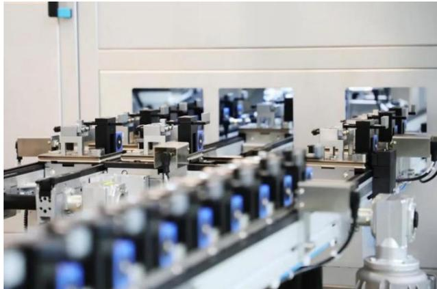
缸内直喷发动机喷油嘴装配线项目正是解决了目前国内高压喷油嘴装配工艺难点。通过突破了层层技术难关，实现了包括角度检测系统、激光平面圆周焊接工艺、高压低流量泄漏测试、Pole piece（磁极块）和 Body（本体）的圆周激光焊接工艺、产品追溯系统、柔性生产等技术。创新性的完成了我国首条缸内直喷发动机喷油嘴装配线，填补了装配制造在汽车直喷发动机喷油嘴领域的空白；同时，该生产线的成功研发将拓宽国内激光焊接工艺在高精密零部件的适用范围，使得行业的自动化装配水平上一新的台阶。目前，整条中国制造的缸内直喷发动机喷油嘴装配线正在国际顶尖的汽车发动机关键零部件意大利马瑞利公司的现场进行验证，随着全新产线的投入使用，该项目将会行业内起到很好的示范作用。
