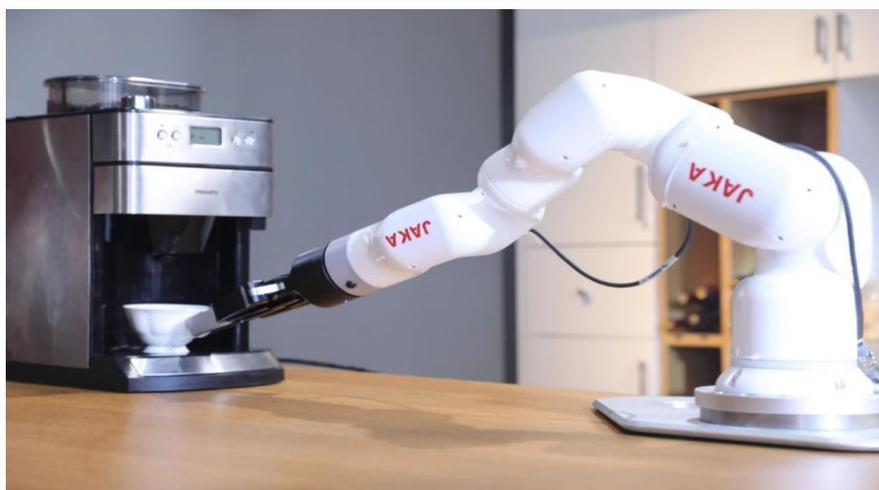
节卡 MiniCobo 协作机器人的外观小巧精致，操作简单直观，低噪音，高性价比（重复定位精度±0.1mm，工具端最大速度 1.5m/s）。特别适合消费、服务、教育、新零售等领域。
