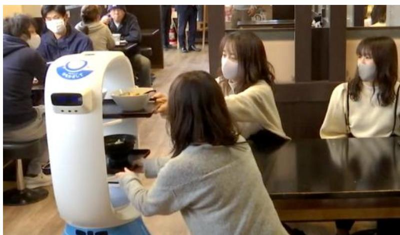
该款送餐机器人采用擎朗智能自研的全自主定位导航技术，激光雷达方案和视觉方案相融合，更好地实现 SLAM 建图、定位以及路径规划效果；避障方面，在激光雷达传感器基础上，增加了机器视觉、深度视觉等多传感器，使机器人自主获取外界信息，进行数据采集，快速识别环境，做出更合理的反应决策。如果将机器人的全自主移动类比成在室内运行的“无人驾驶”技术，擎朗送餐机器人的技术和解决方案相当于可以达到 L4 级别。
