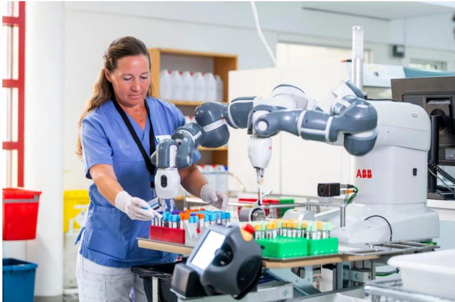
安装一台 ABB 协作机器人确实减轻了手工取样过程的工作负担。有了 YuMi 协作机器人，实验室的工作人员可以从重复性工作中解放出来，完成其他工作任务。同时，他们也不再需要忍受重复性工作造成的手腕和肩膀疼痛。
