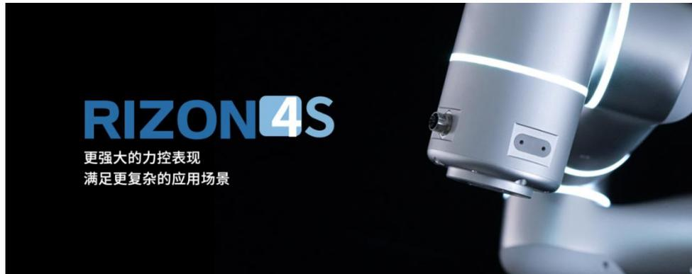
由于 Rizon 4s 的末端感知精度可达 0.03N，在机械臂末端放置一颗小小的螺丝钉，机器人都可以快速敏锐地感知其微小的重量。这样的末端高精度力感知和力控可以保证机器人在操作任务时，无需额外的力觉传感器或者带有浮动补偿的力控装置，而凭借本身加上必要的末端工具就能实现非常出色的作业效果。
