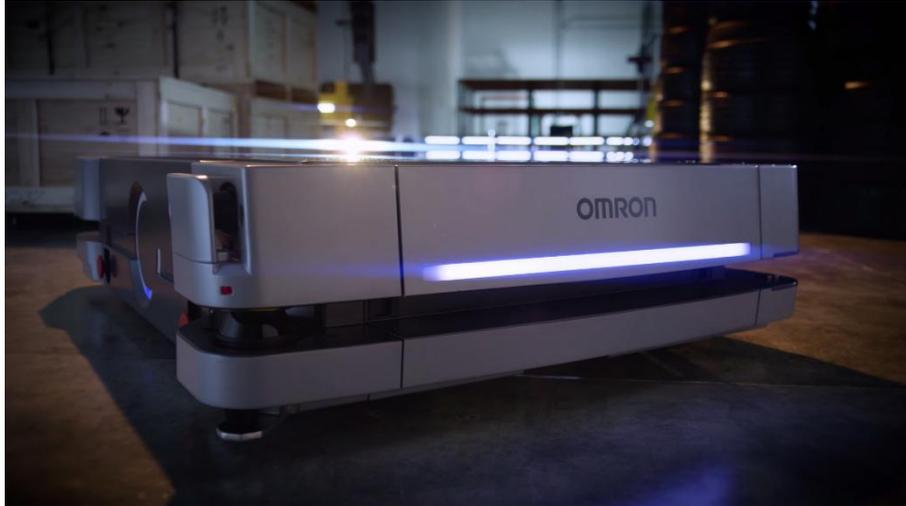
HD1500 还可以替代叉车作业，从而较大程度降低人工作业风险。HD-1500 可与欧姆龙集成式移动车队进行无缝协作，使客户在开发定制移动解决方案时有更多选择。
